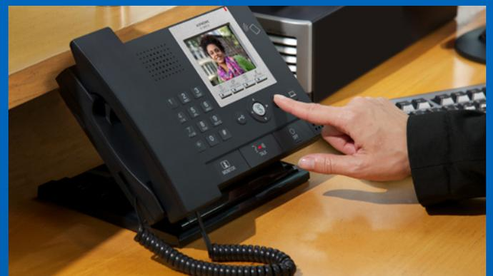
La unidad para guardias con video ofrece una capa de seguridad adicional para inspeccionar a los visitantes y comunicarse con los usuarios
